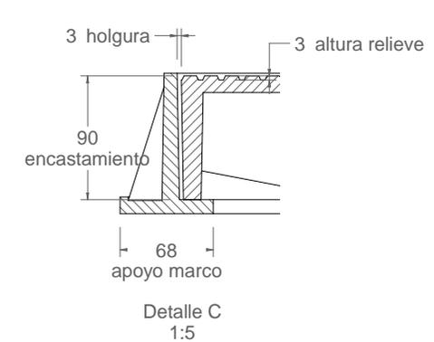
Material: Fundicion ductil GGG40
