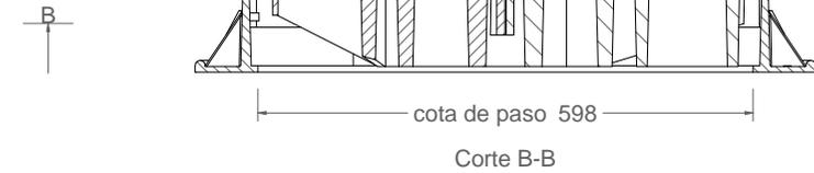
Material: Fundición ductil GGG40
