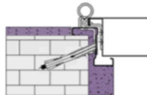
El marco va preparado con agujeros para su atornillado en la obra soporte. El marco se debe calzar en los puntos de atornillado. Interiormente, se debe rellenar con mortero todo los huecos entre marco y obra, como muestra la imagen. Se recomienda utilizar tacos metálicos de expansión de Ø10x120. **⚠** No se suministran los tornillos de instalación.
